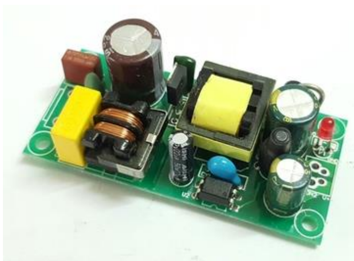
スイッチング方式 DC-DCコンバータ
