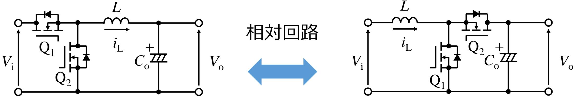
**降圧** 型コンバータに **入力** キャパシタを挿入して **出力** 側から見ると **昇圧** 型コンバータとなる
