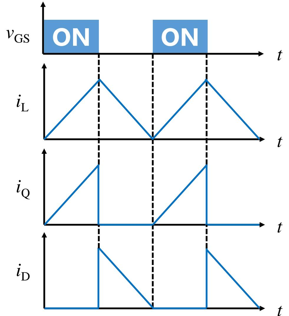
リップルが連続導通モードと比べて大きくなる上に電流に **ゼロ** の点が生じるよう制御するため、**周波数** が変化する
