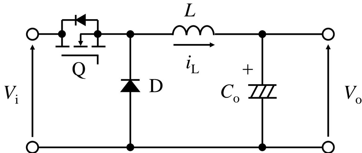
リップルが最も **大きい** が、ターンオン時は電流がゼロから切り替わるため、**リカバリ電流** が発生せず **高効率** (ソフトスイッチングも実現できている)
