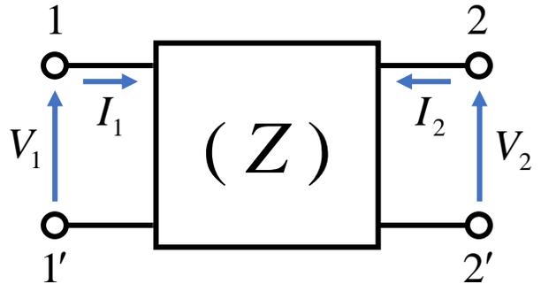
$$\begin{bmatrix} V_1 \\ V_2 \end{bmatrix} = \begin{bmatrix} z_{11} & z_{12} \\ z_{21} & z_{22} \end{bmatrix} \begin{bmatrix} I_1 \\ I_2 \end{bmatrix}$$
