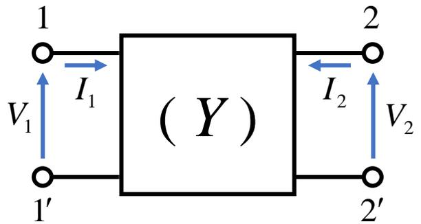
$$\begin{bmatrix} I_1 \\ I_2 \end{bmatrix} = \begin{bmatrix} y_{11} & y_{12} \\ y_{21} & y_{22} \end{bmatrix} \begin{bmatrix} V_1 \\ V_2 \end{bmatrix}$$
