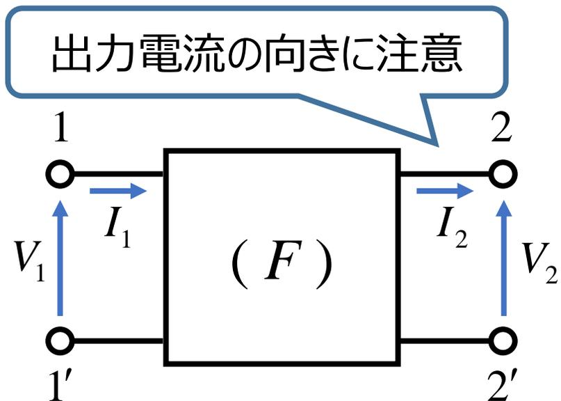
$$\begin{cases} V_1 = AV_2 + BI_2 \\ I_1 = CV_2 + DI_2 \end{cases} \quad \rightarrow \quad \begin{bmatrix} V_1 \\ I_1 \end{bmatrix} = \begin{bmatrix} A & B \\ C & D \end{bmatrix} \begin{bmatrix} V_2 \\ I_2 \end{bmatrix}$$
