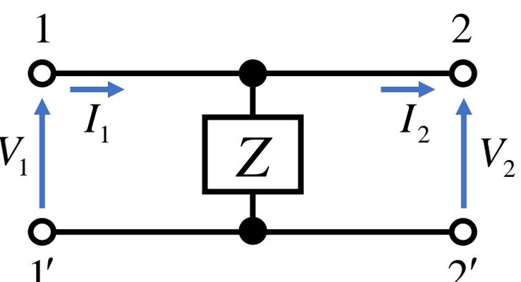
$$\begin{cases} V_1 = V_2 = V_2 + 0I_2 \\ I_1 = (1/Z)V_2 + I_2 \end{cases}$$
