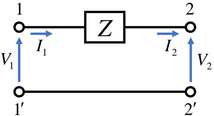
$$\begin{cases} V_1 = V_2 + ZI_2 \\ I_1 = I_2 = 0V_2 + I_2 \end{cases}$$
