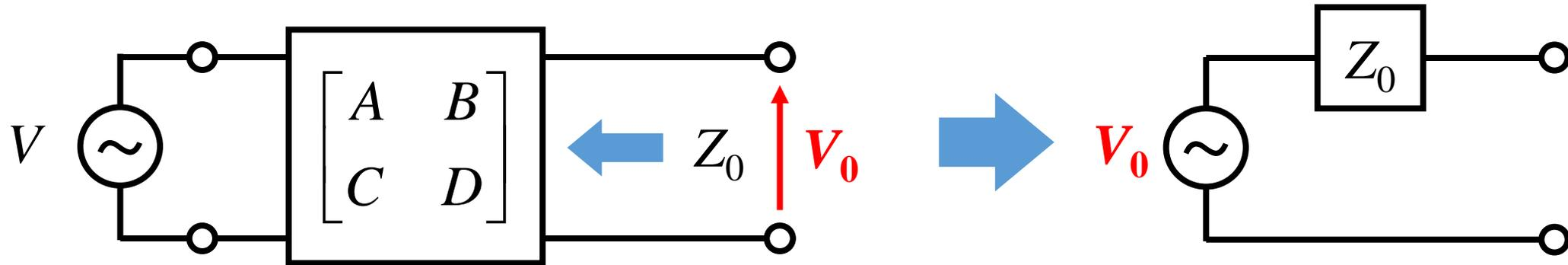
等価電圧源  $V_0$  = 端子 **2** を開放したときの **開放** 電圧
