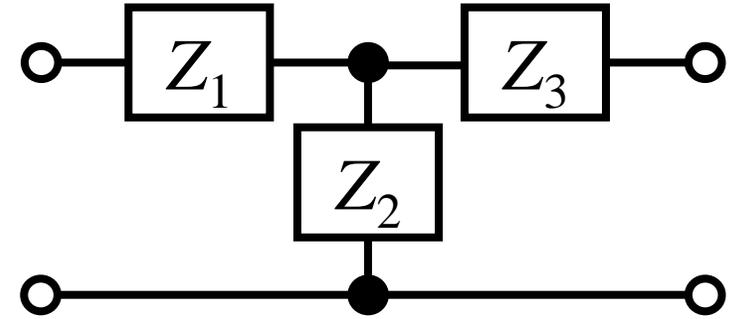
$$\begin{bmatrix} A & B \\ C & D \end{bmatrix} = \begin{bmatrix} 1 & Z_1 \\ 0 & 1 \end{bmatrix} \begin{bmatrix} 1 & 0 \\ \frac{1}{Z_2} & 1 \end{bmatrix} \begin{bmatrix} 1 & Z_3 \\ 0 & 1 \end{bmatrix} = \begin{bmatrix} 1 + \frac{Z_1}{Z_2} & Z_1 + Z_3 + \frac{Z_1 Z_3}{Z_2} \\ \frac{1}{Z_2} & 1 + \frac{Z_3}{Z_2} \end{bmatrix}$$
