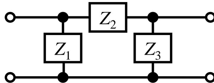
$$\begin{bmatrix} A & B \\ C & D \end{bmatrix} = \begin{bmatrix} 1 & 0 \\ \frac{1}{Z_1} & 1 \end{bmatrix} \begin{bmatrix} 1 & Z_2 \\ 0 & 1 \end{bmatrix} \begin{bmatrix} 1 & 0 \\ \frac{1}{Z_3} & 1 \end{bmatrix} = \begin{bmatrix} 1 + \frac{Z_2}{Z_3} & Z_2 \\ \frac{1}{Z_1} + \frac{1}{Z_3} + \frac{Z_2}{Z_1 Z_3} & 1 + \frac{Z_2}{Z_1} \end{bmatrix}$$
