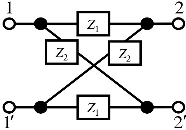
$$\begin{bmatrix} A & B \\ C & D \end{bmatrix} = \begin{bmatrix} \frac{Z_1 + Z_2}{Z_2 - Z_1} & \frac{2Z_1Z_2}{Z_2 - Z_1} \\ \frac{2}{Z_2 - Z_1} & \frac{Z_1 + Z_2}{Z_2 - Z_1} \end{bmatrix}$$
