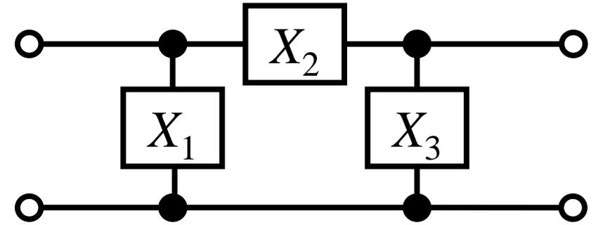
$$[F_T] = \begin{bmatrix} 1 + \frac{Z_1}{Z_2} & Z_1 + Z_3 + \frac{Z_1 Z_3}{Z_2} \\ \frac{1}{Z_2} & 1 + \frac{Z_3}{Z_2} \end{bmatrix}$$
