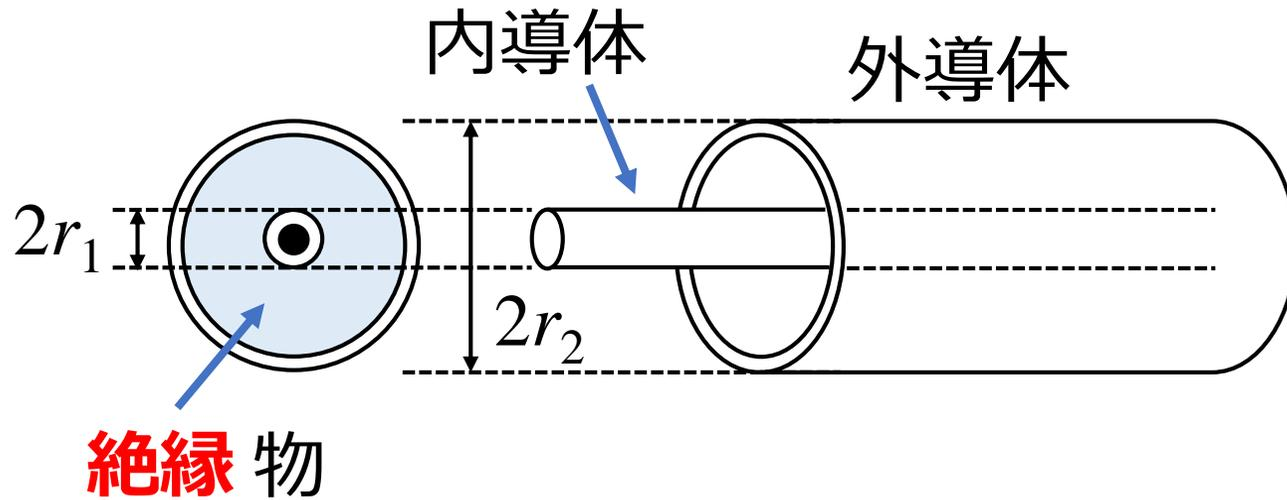
円筒導体の軸に円形断面の導体を入れたもの
