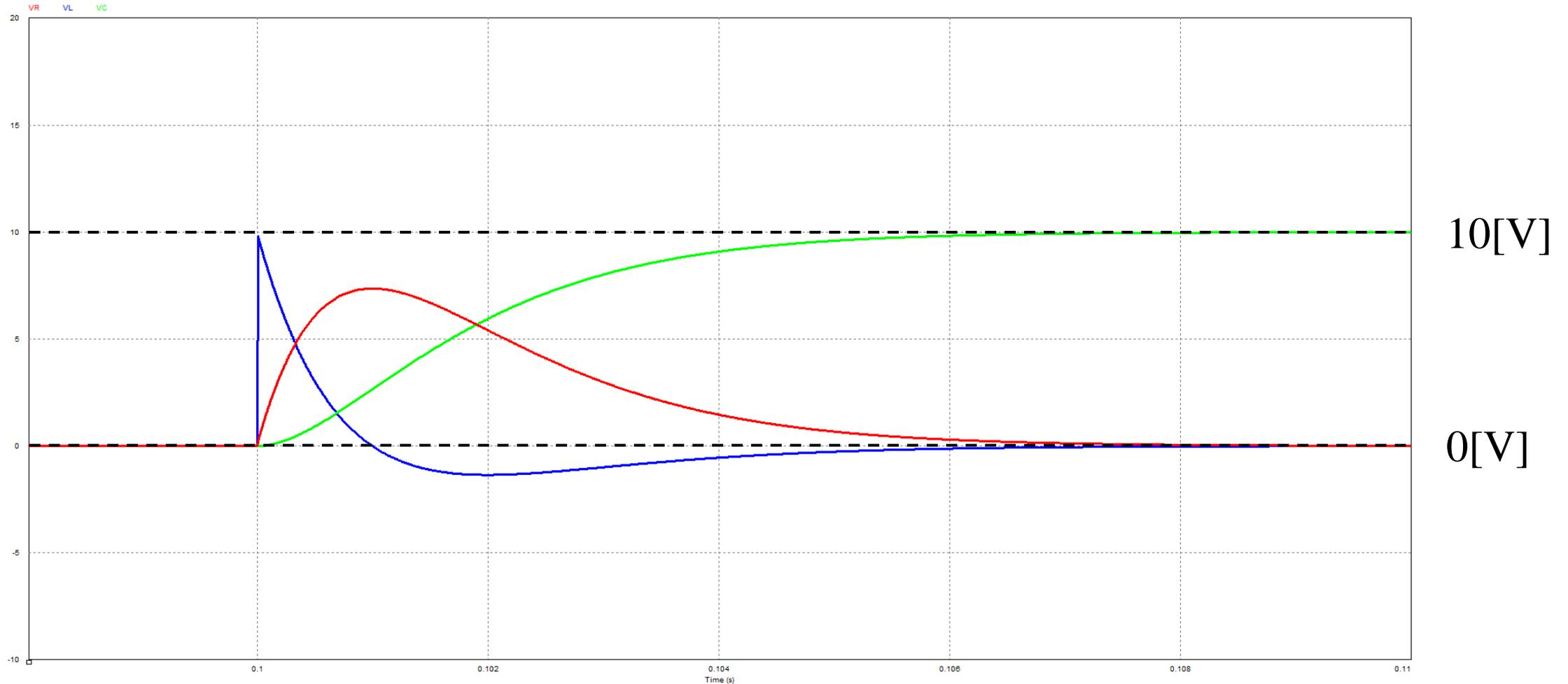
$V = 10\text{[V]}$ ,  $R = 2\text{[}\Omega\text{]}$ ,  $L = 10\text{[mH]}$ ,  $C = 10\text{[mF]}$ , 赤： $v_R(t)$ , 青： $v_L(t)$ , 緑： $v_C(t)$
