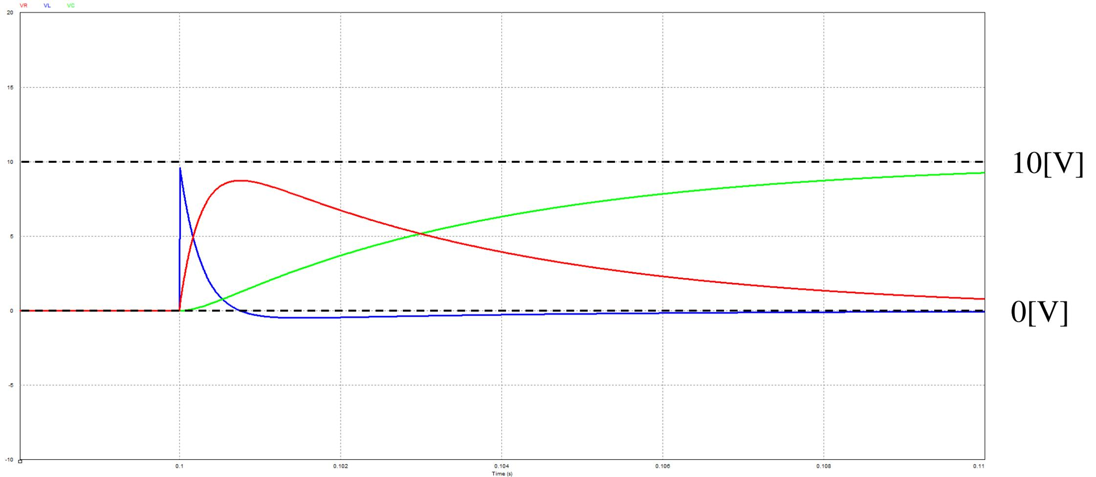
$V = 10[\text{V}]$ ,  $R = 4[\Omega]$ ,  $L = 10[\text{mH}]$ ,  $C = 10[\text{mF}]$ , 赤： $v_R(t)$ , 青： $v_L(t)$ , 緑： $v_C(t)$
