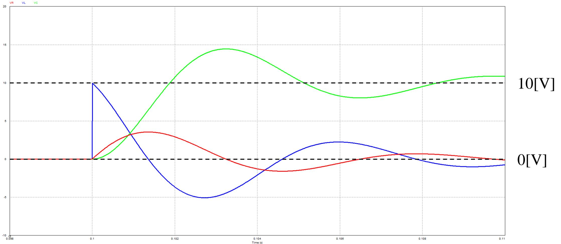
$V = 10\text{[V]}$ ,  $R = 0.5\text{[}\Omega\text{]}$ ,  $L = 10\text{[mH]}$ ,  $C = 10\text{[mF]}$ , 赤 :  $v_R(t)$ , 青 :  $v_L(t)$ , 緑 :  $v_C(t)$
